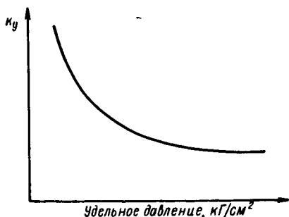
Рис. 136. Зависимость усадочного коэффициента керамических материалов от удельного давления при оформлении изделий
