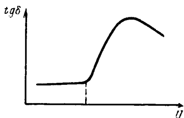
Рис. 73. Изменение \text{tg } \delta в зависимости от напряжения для изоляции с воздушным включением [Л. 7]
